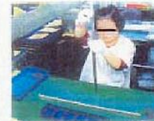
④ゲージ通し (1回) 確実にする 左手で立て右手でゲージを上一下 左手はゲージの下に添えるように
